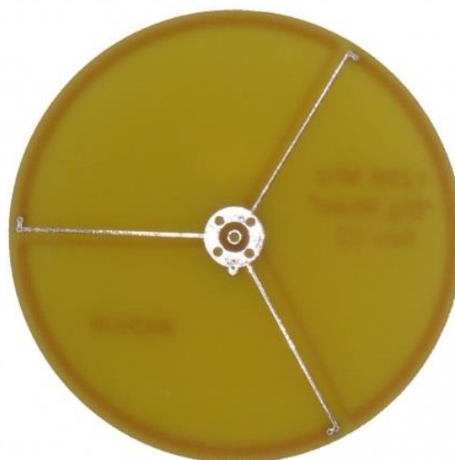
Fot. 5.3.4-5.3.5. Drukowana antena na pasmo 23 cm ma średnicę 72 mm, impedancję wejściową 50 \Omega i zysk kierunkowy 2 dBi
