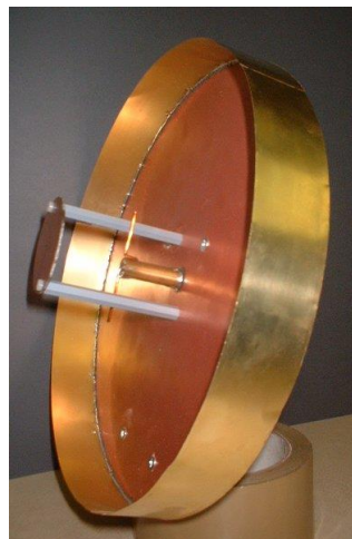
Rys. 2.2.3. Przykład realizacji anteny na pasmo 2,4 GHz
