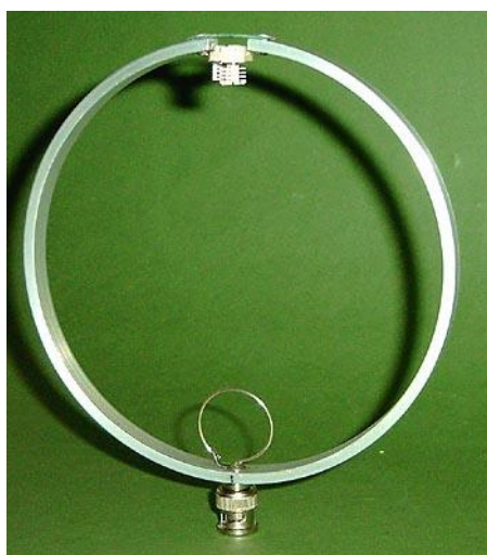
Fot. 6.2 – 6.3. Przykłady wykonania anten magnetycznych na pasma 2 m i 70 cm do radiostacji ręcznych
