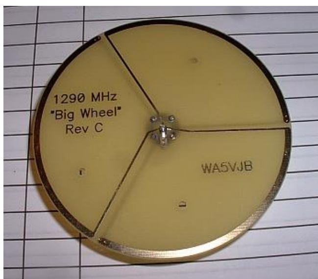
Fot. 5.3.4-5.3.5. Drukowana antena na pasmo 23 cm ma średnicę 72 mm, impedancję wejściową 50 \Omega i zysk kierunkowy 2 dBi
