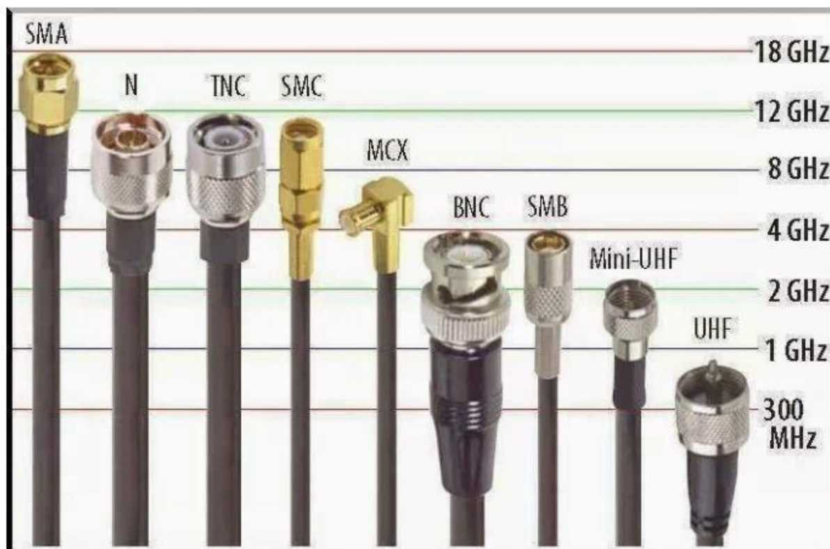
Fot. 7.6.1. Zakresy pracy najbardziej rozpowszechnionych wtyków koncentrycznych
